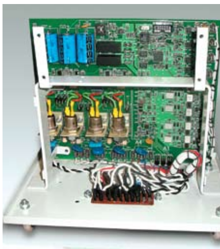
Рис. 5. Генератор кодов КЭБ-1 на современной элементной базе
